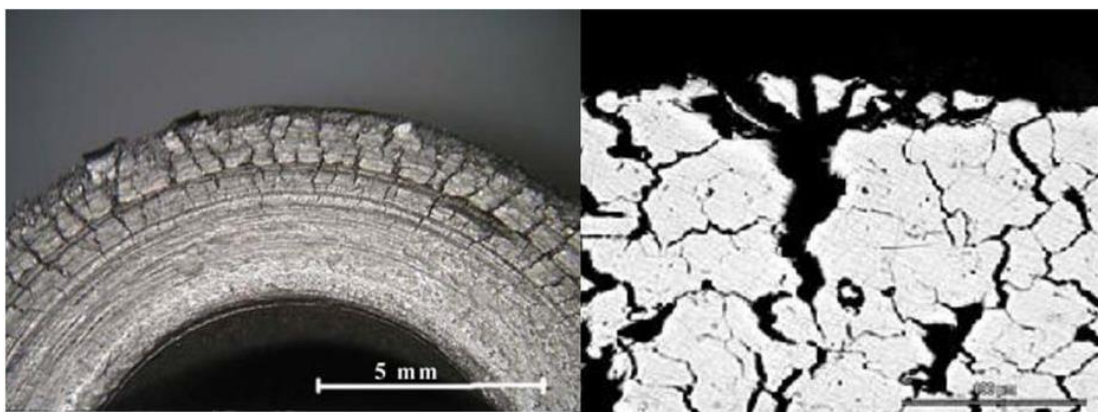
Obr. 7 Mezikrystalová koroze korozivzdorné oceli 10CrNi 8-10 (8)
