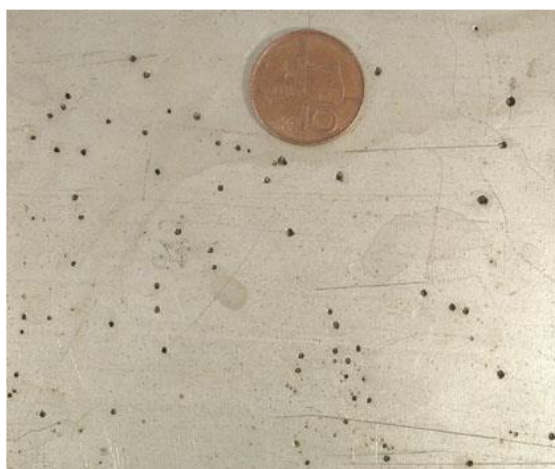
Obr. 4 Bodová koroze korozivzdorné oceli. (3)
