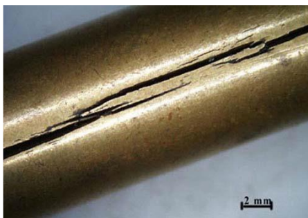
Obr. 9 Korozní praskání mosazi (2)
