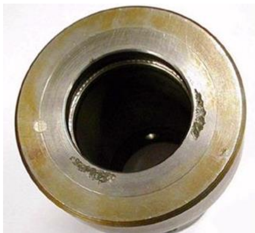
Obr. 6 Štěrbínová koroze příruby potrubí z korozivzdorné oceli typu CrNi 18-8 (1)
