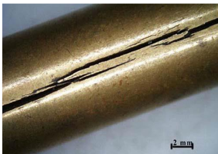
Obr. 9 Korozní praskání mosazi (2)
