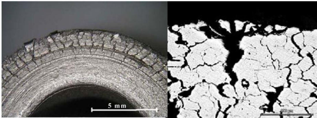
Obr. 7 Mezikrystalová koroze korozivzdorné oceli 10CrNi 8-10 (8)
