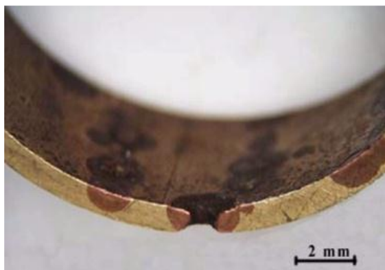
Obr. 8 Selektivní koroze – odzinkování mosazi (6)
