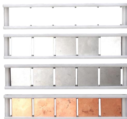
Zkušební destičky (korozní kupony) v plastových držácích – rozměr á 42x42x1 mm
