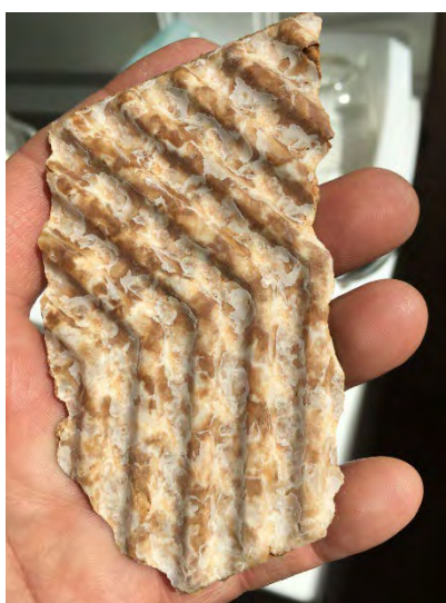
Vodní kámen z deskového výměníku
