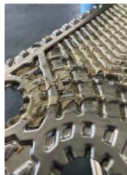
Usazeniny na oběhovém čerpadle a deskovém výměníku
