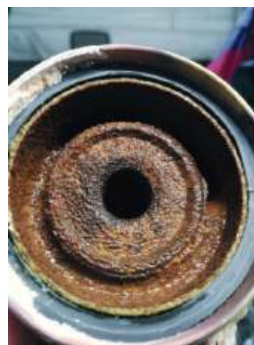
Usazeniny na oběhovém čerpadle a deskovém výměníku
