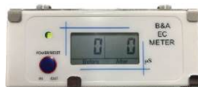
Konduktometr je součástí jednotek AVDK.
