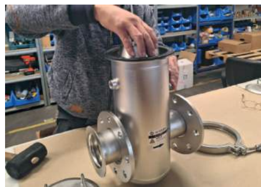
Servis filtru RD2.3 – magnet a filtrační vložka
